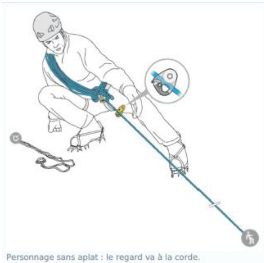
2 Réalisation d'un ancrage sur corp mort
